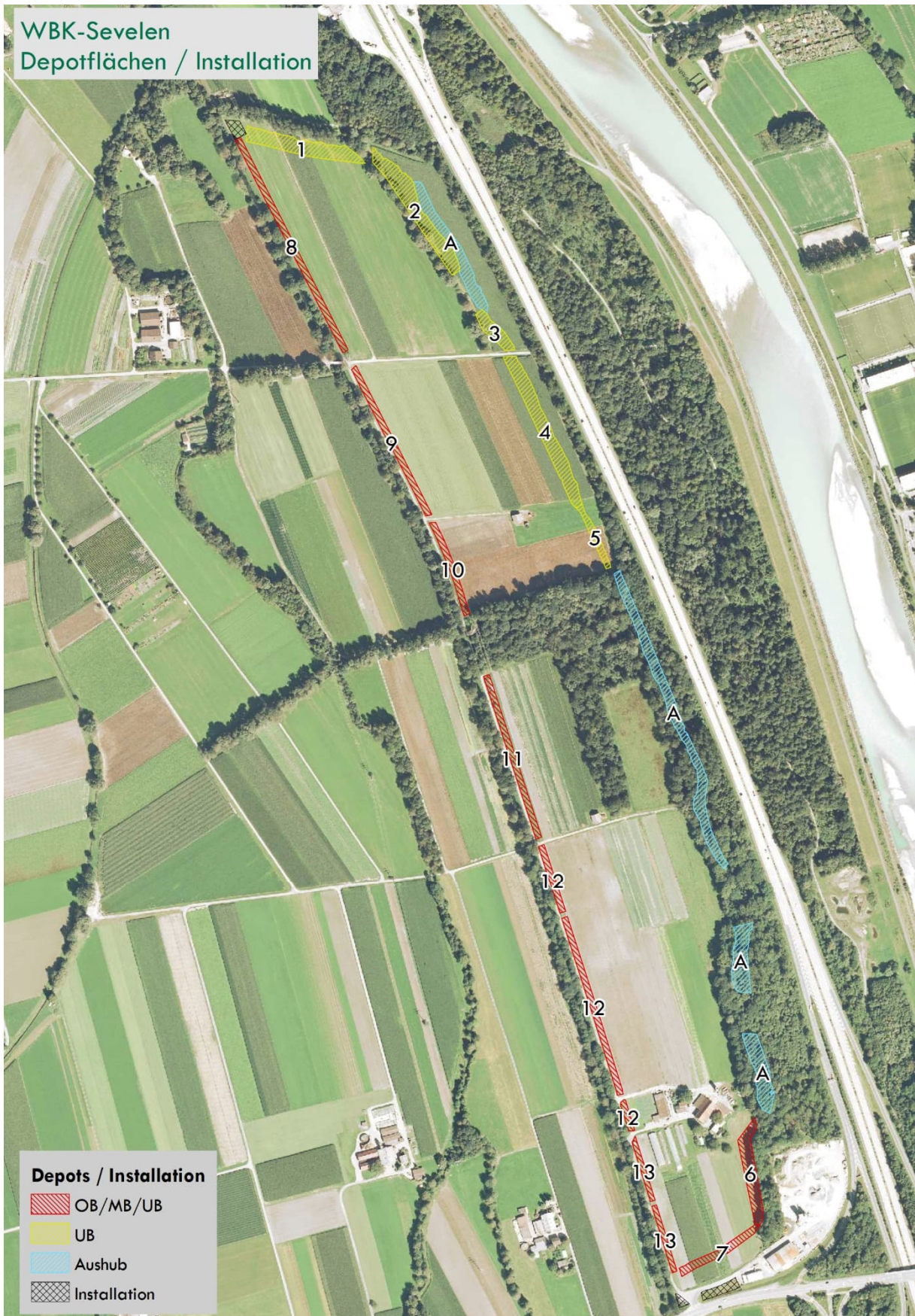
Abb. 26: Zwischenlagerflächen für Aushubmaterial (M. Zahner)
